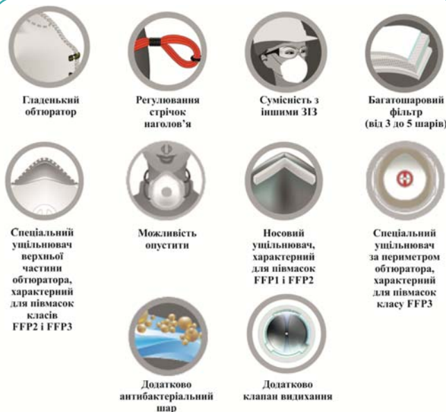
Рис. 2. Особливі конструктивні елементи фільтрувальних півмасок
